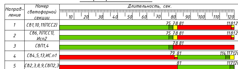
Режим работы светофорной сигнализации (1 программа 120с)
